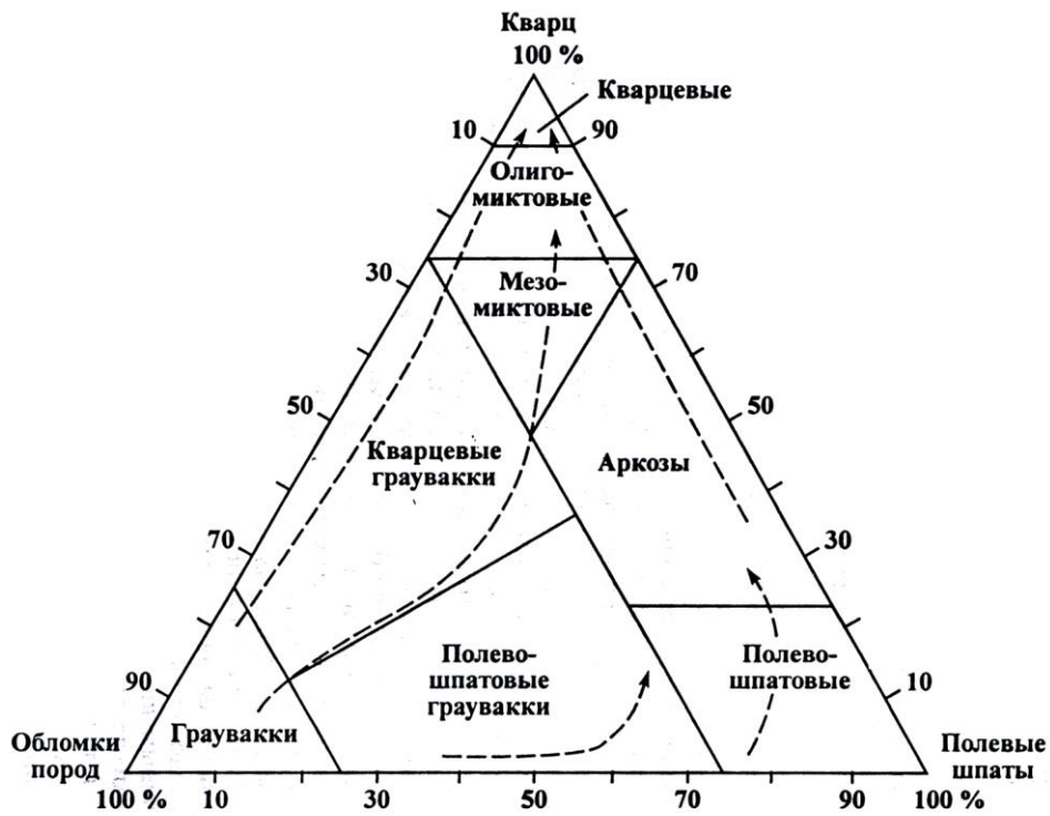
Рис.3.1. Классификация песчано-алевритовых пород по их минерально-петрографическому составу (по В. Н. Шванову, 1987).
